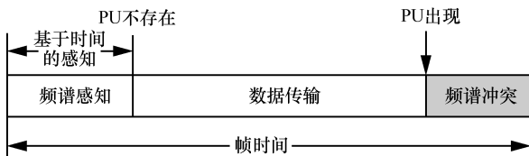
图 5 基于时间的频谱感知模型
