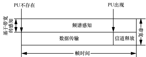
图 6 基于带宽的频谱感知模型
